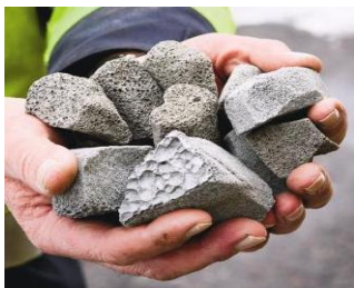
Figur 2.6 Skumglas kan användas som fyllnadsmaterial på exempelvis terrassbjälklag.
